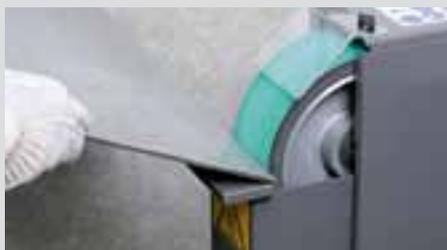
Příprava svaru téměř bez vibrací, maximální úběrové výkony a nízké náklady na nástroje: S kvalitou brusného pásu GRIT „R“.
