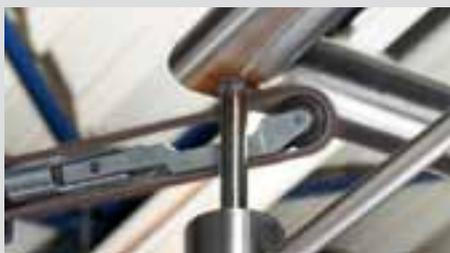
Ideální pro těžko dostupná místa: Snadno ovladatelný pásový pilník BF 10-280 E s otočným brusným ramenem.
