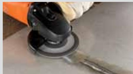
Broušení s vysokým točivým momentem, ale sníženými otáčkami s vějířovitými kotouči. Tím se zabrání tvorbě tepla na materiálu.
