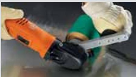
Plošné broušení s brusnými pouzdry pro vynikající úběrový výkon.
