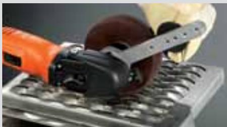
Rychlé a účinné čištění trubek a profilů: Vlněné rouno je optimální pro všechny struktury.
