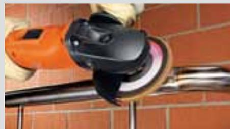
Odstraňování svarů bez poškození sousedních ploch: Se speciálním vějířovitým kotoučem FEIN medium.
