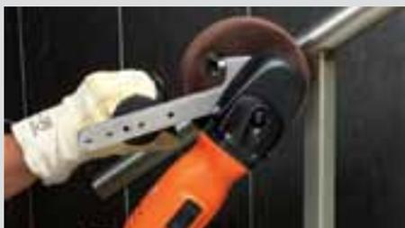
Brusné a leštící zařízení WPO 14-25 E: Efektivní odstraňování náběhových barev. Flexibilní vlněná rouna se optimálně přizpůsobí tvarům obrobků.
