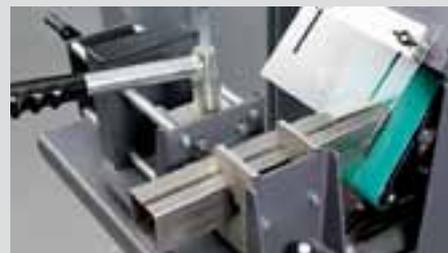
Přesné broušení úkosů deskou na broušení úkosů ve spojení s GIR.
