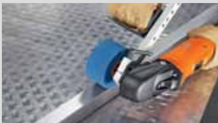
Pro profily z ušlechtilé oceli a plochý materiál: Satinovací finiřování díky lamelovým rounovým kotoučům.
