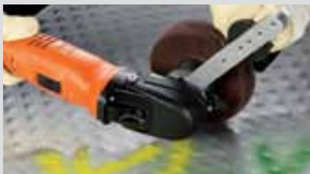
Čištění a finiřování velkých ploch, rychle a efektivně. Vlněné rouno se optimálně přizpůsobí strukturovanému materiálu.
