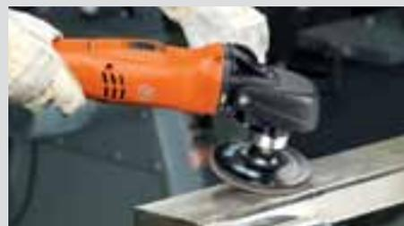
Leštění profilů – optimálně připraven za pomoci Pyramixu při rotačním postupu.
