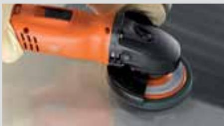
Bodové vybroušení lehkých škrábanců s finiřovacím kotoučem. U hlubších škrábanců brusné kotouče „Pyramix“ se suchým zipem.
