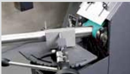
Tvarově přesné vybroušení oblouků během několika vteřin s válcovými brusnými moduly GRIT.
