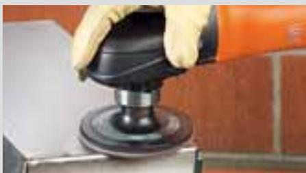
Účinné odstranění náběhových barev vlněným rounem nebo rounovým kotoučem. Pro optimální přizpůsobení svarům.
